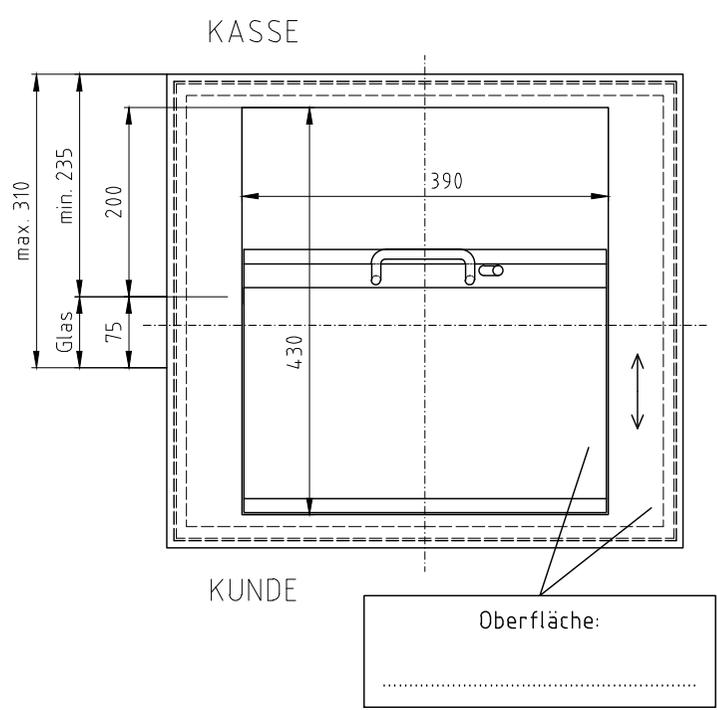
DIE SCHIEBEMULDE WIRD VON OBEN IN DEN VORBEREITETEN AUSSCHNITT EINGESETZT ODER VON DER KASSESEITE EINGESCHOBEN. DER ANTRIEB ERFOLGT MECHANISCH.
