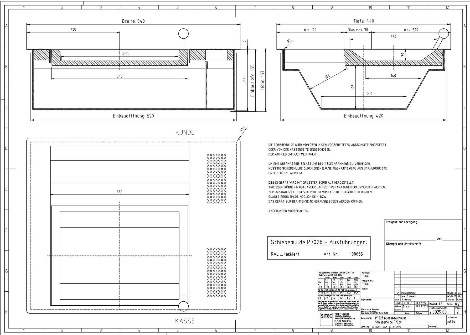
DIE SCHIEBEMULDE WIRD VON OBEN IN DEN VORBEREITETEN AUSSCHNITT EINGESETZT ODER VON DER KASSESEITE EINGESCHOBEN. DER ANTRIEB ERFOLGTT MECHANISCH.
