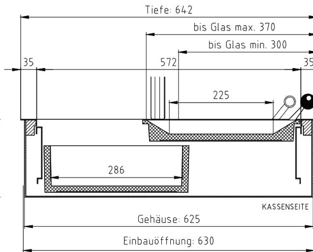
DIE SCHIEBEMULDE WIRD VON OBEN IN DEN VORBEREITETEN AUSSCHNITT EINGESETZT ODER VON DER KASSESEITE EINGESCHOBEN. DER ANTRIEB ERFOLGTT MECHANISCH.
