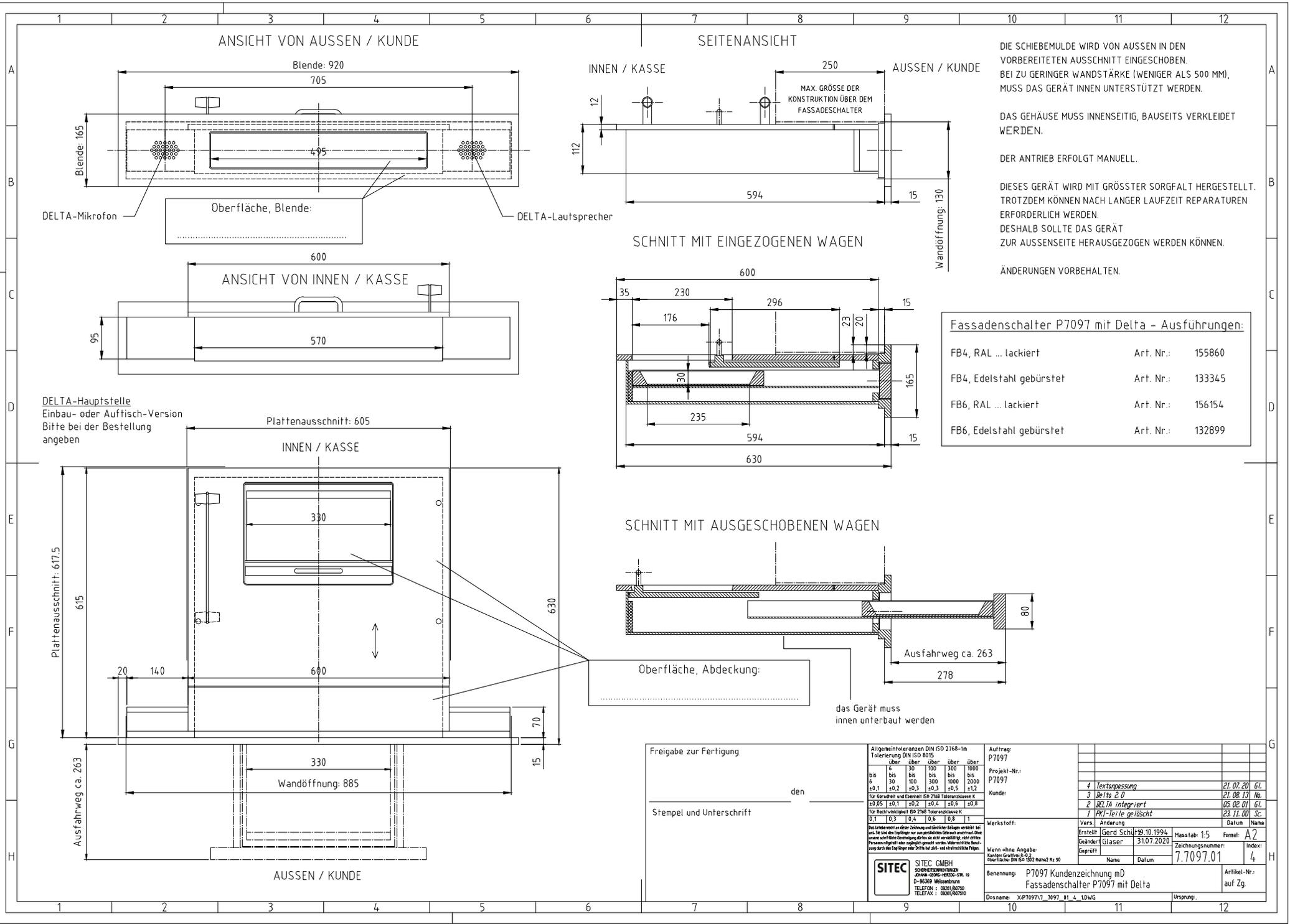
DIE SCHIEBEMULDE WIRD VON AUSSEN IN DEN VORBEREITETEN AUSSCHNITT EINGESCHOBEN. BEI ZU GERINGER WANDSTÄRKE (WENIGER ALS 500 MM), MUSS DAS GERÄT INNEN UNTERSTÜTZT WERDEN.
