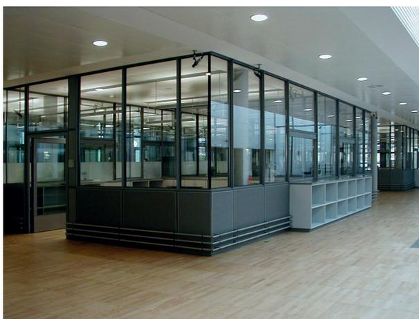
Ungesicherter Bereich mit schallhemmenden Trennwänden.
