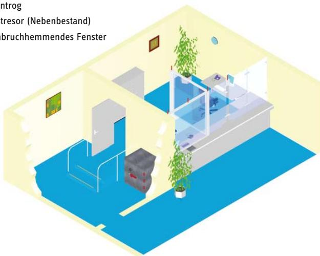
Bild 24: Grundriss mit durchschusshemmendem Schirm
